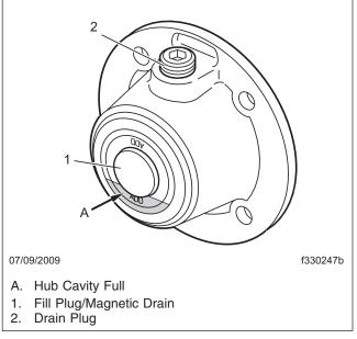
Fig. 5, Oil-Filled Hub Cap
