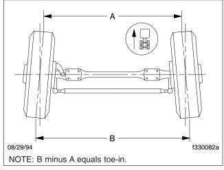
Fig. 6, Wheel Toe-In (overhead view)
